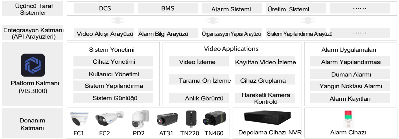
Üç Katmanlı Termal Güvenlik Altyapısı: Donanım, Veri ve Sistem Entegrasyonu
