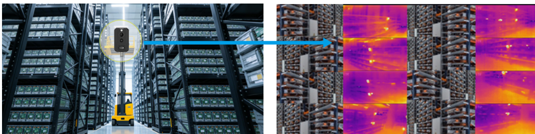
AGV'lere Monte Edilen Termal Kameralar, Yüksek Yoğunluklu Raflardaki Bataryaların Gerçek Zamanlı Denetimini Sağlar
