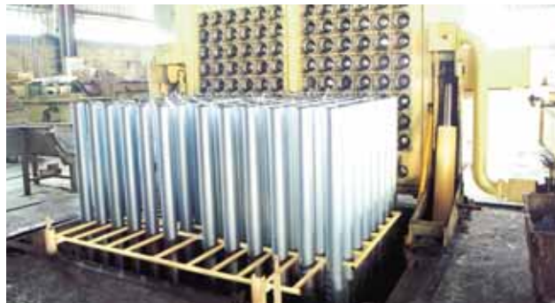
Biyet döküm tesisi. Pürüzsüz yüzey kalitesi ve homojen tane yapısı.
